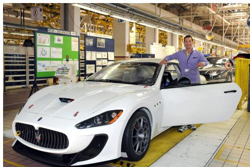
Die Wettbewerbsfahrzeuge basieren auf dem Maserati Gran Turismo S. Die Techniker der Rennwagenabteilung von Maserati Corse steigerten die Leistung des 4,7-Liter-V8-Motors um 8 kW / 10 PS auf 331 kW / 450 PS. Das maximale Drehmoment kletterte von 490 Newtonmeter auf 510 Nm.
